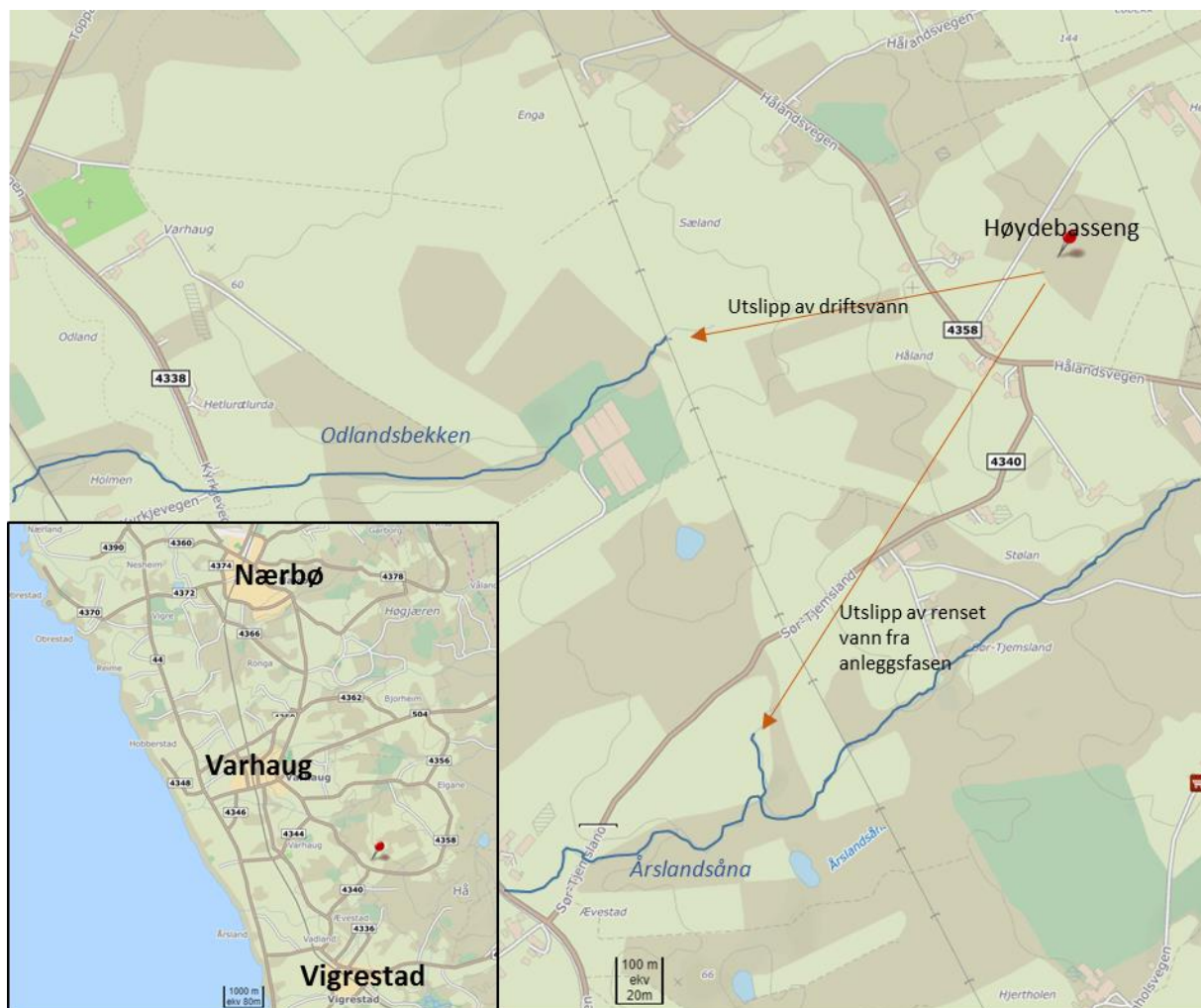
Figur 2.1. Lokalisering av det nye høydebassenget på Håland (rød nål). Et oversiktskart er vist i nedre, venstre hjørne.
